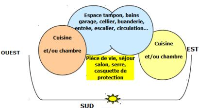
Aménager des espaces tampons au nord permet de réduire l'impact du froid et contribuera directement aux économies d'énergies et au confort des occupants.
